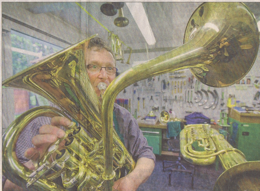
Sonderanfertigung: Gottfried Büchel testet das für die australische Komponistin Liz Lim aufwendig umgebaute Euphonium, das nun über ein zweites Schallrohr verfügt.
